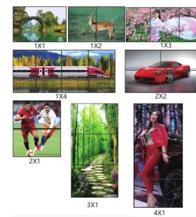
温馨提示: 按机器MODE或遥控器上对应的拼接键, 实现多种图像拼接效果, 拼接方式如1X1、1X2、1X3、1X4、2X2、2X1、3X1、4X1 (行X列)
