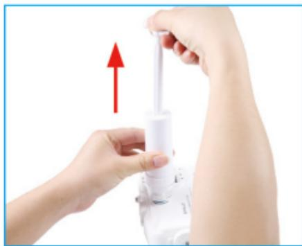
5. Use la bomba de aire para bombear el vacío y la instalación completa.
