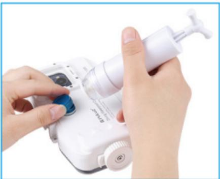
4. Öffnen Sie die Abdeckung des Einwegventils.
